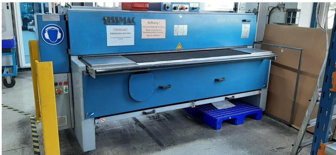
Beidseitige Entgratung und Kantenverrundung von Stahl und Edelstahl in nur einem Arbeitsgang.
